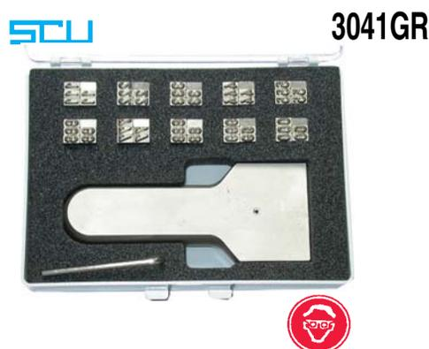
Qualità Extra. Caratteri in acciaio speciale temprato per punzonare metalli. Durezza parte incisa HRc 60/61. Supporto porta-caratteri in acciaio con testa a tempra differenziata, per evitare scheggiature e stelo godronato. Si possono formare scritte o numeri a piacere, con distanziature a scelta, punzonando con una sola battuta. Confezione in cofanetto.
